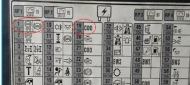
همانطور که در تصویر فوق ملاحظه میکنید در تصویر صفحه راهنما محل هر فیوز با شماره آن و مقدار جریان فیوز، همچنین مصرف کننده ای که مریبوط به آن فیوز می باشد مشخص شده است.
