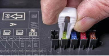
همانطوری که در تصویر ملاحظه میکنید تعویض فیوز سوخته توسط گیره مخصوص که در تابلو برق یا جعبه فیوز خودرو وجود دارد انجام
