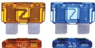
فیوزهای مورد استفاده در تابلو برق اسکانیا از نوع فیوز پلاستیکی می باشند همانند شکل بالا این فیوزها دارای بدنه شفاف بوده و با نگاه کردن به آن می توان متوجه سالم یا خراب بودن آن شد از این طریق که اگر قطعه نوار فلزی داخل فیوز وصل باشد فیوز سالم است در صورتیکه نوار فلزی قطع شده باشد فیوز سوخته و باید آن را تعویض کرد.
